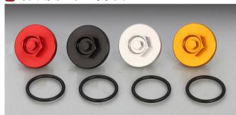
エンジンのドレスアップに最適なアルミ削り出しストレーナーキャップです。マグストレーナーキャップは磁石を内蔵することでエンジン内を循環しているオイルに混ざった鉄粉を磁力で引き寄せ吸着、エンジンオイルをクリーンに保つことが可能です。ストレーナーキャップ、ドレンキャップとして使用 できます。
